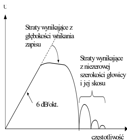
Rys. 7-11. Główne czynniki wpływające na ograniczenie pasma zapisu magnetycznego
